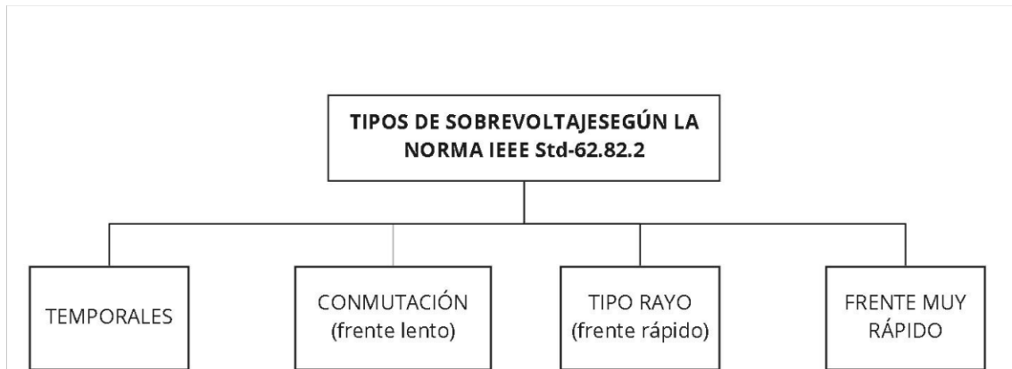
Figura 1.1. Tipos de Sobrevoltajes según la norma IEEE Std-62.82.2. Elaboración propia en base a la referencia [1].
