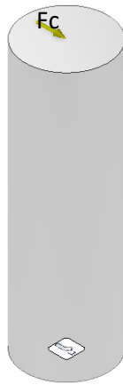
Figura 41. Pin sometido a una fuerza de corte.
