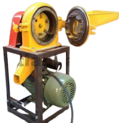
Figura 9. Molino de pines 2HP harinero. [19]
