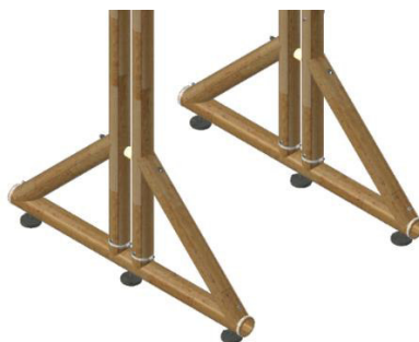
Figura 3.1. Uso de niveladores en la base de la estructura.
