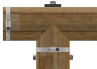
Figura 2.23. Uso de abrazaderas en extremos de la guadúa.
