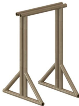
Figura 2.13. Estructura tipo pórtico con uniones emperradas.
