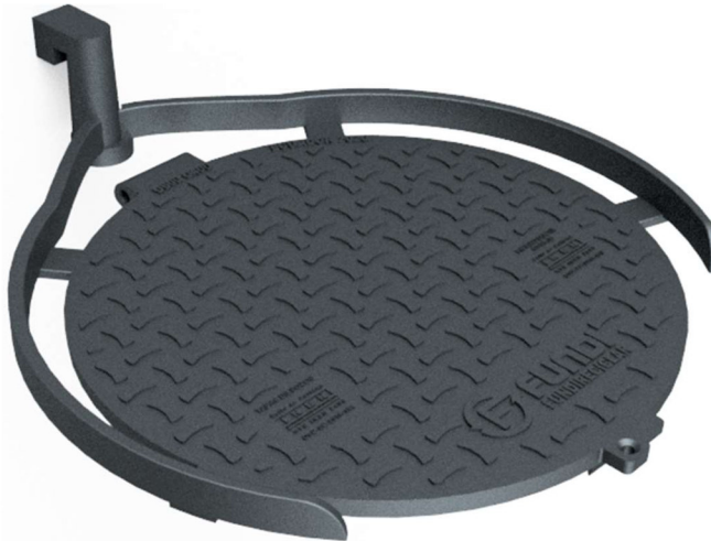
Figura 2.6. Modelo CAD del sistema de alimentación de la tapa D600-C preliminar
