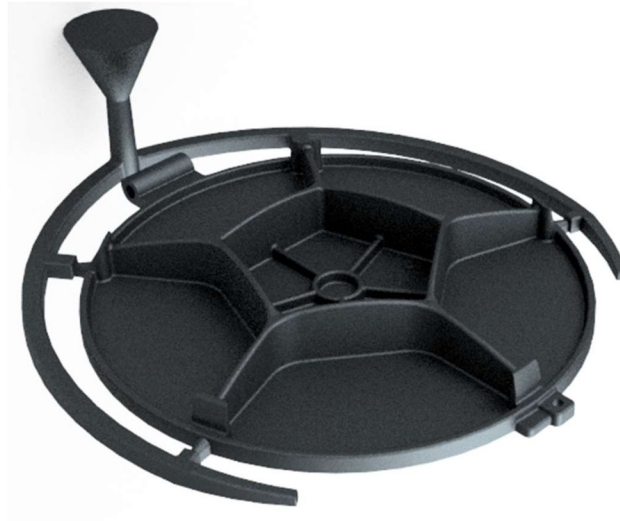
Figura 2.10. Modelo CAD de Sist-Alim.T.V.B.1.
