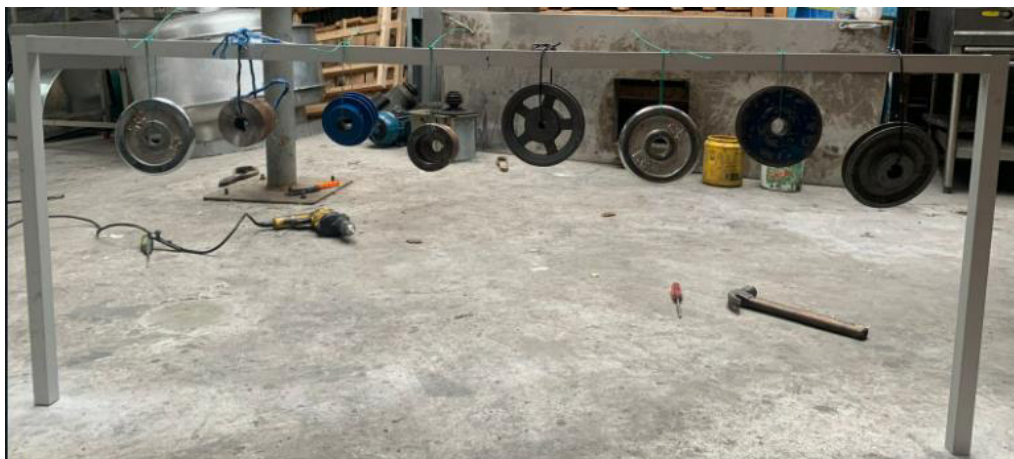
Figura 3.6. Prueba de cargas, soporte fijo (Fuente: Propia)
