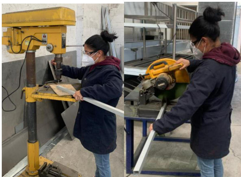
Figura 2.7. Proceso de perforación y corte de tubos (Fuente: Propia)
