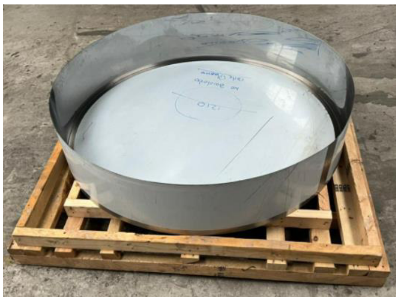
Figura 3.2. Tanque evaporimétrico construido (Fuente: Propia)
