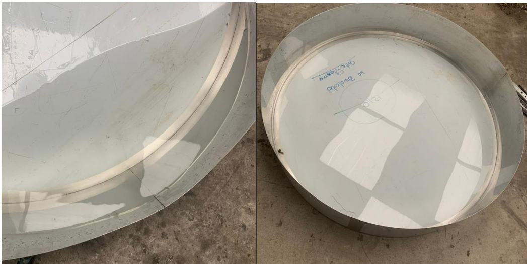
Figura 3.5. tanque con agua, comprobación de fallas (Fuente: Propia)
