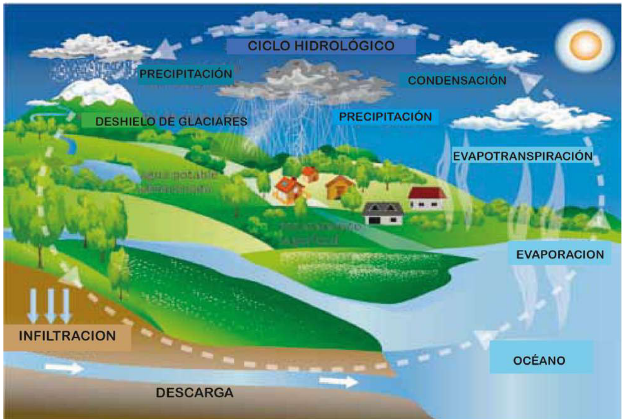
Figura 2.4 Componentes y flujo del agua en el ciclo hidrológico. Modificado de Cotler et al. (2013).
