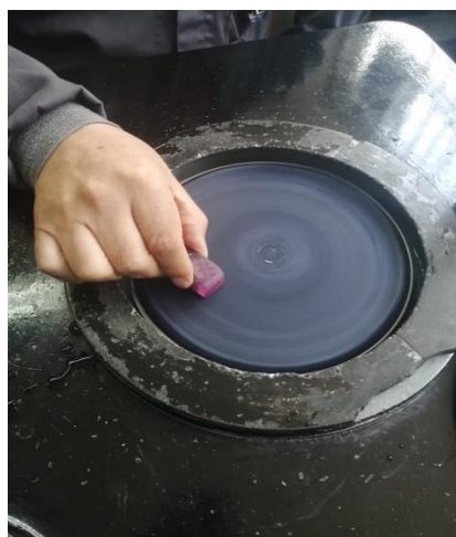
Figura 3.7 Pulido de probetas.
