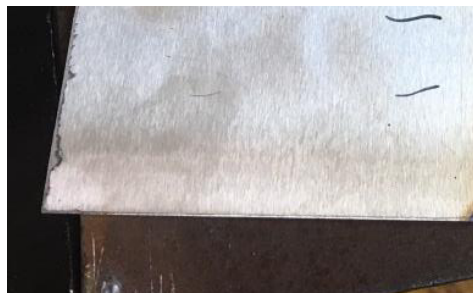
Figura 2.2 Muestra para obtener la microestructura del acero AISI 430 por medio del ensayo de chispa.
