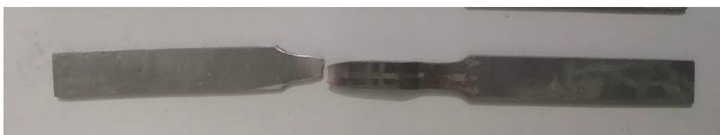
Figura 3.12 Probeta T2.2 con cordón de soldadura doble después del ensayo de tracción.
