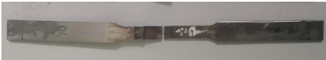
Figura 3.10 Probeta con cordón de soldadura simple después del ensayo de tracción.
