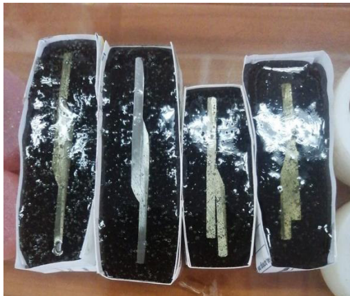
Figura 3.4 Probetas de los cordones de soldadura en la montura de resina poliéster.
