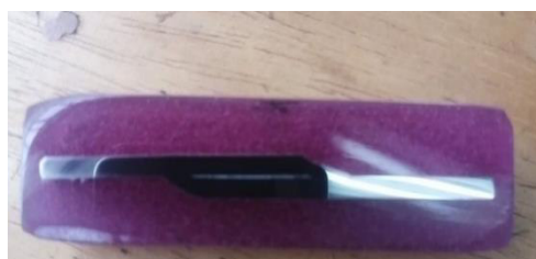
Figura 3.8 Probetas lista para micrografía.
