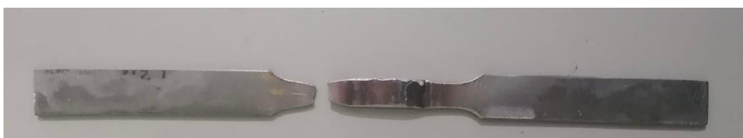
Figura 3.11 Probeta T2.1 con cordón de soldadura doble después del ensayo de tracción.
