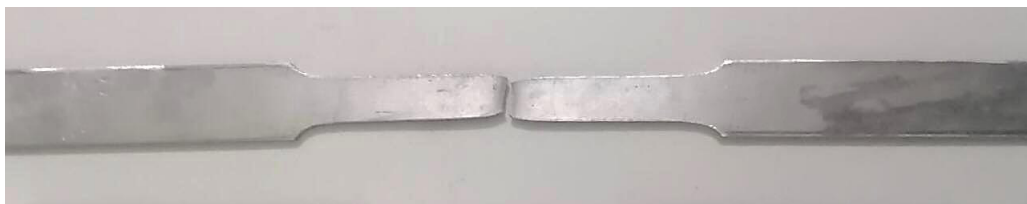
Figura 3.14 Probeta MB2 del material base después de aplicar el ensayo de tracción.
