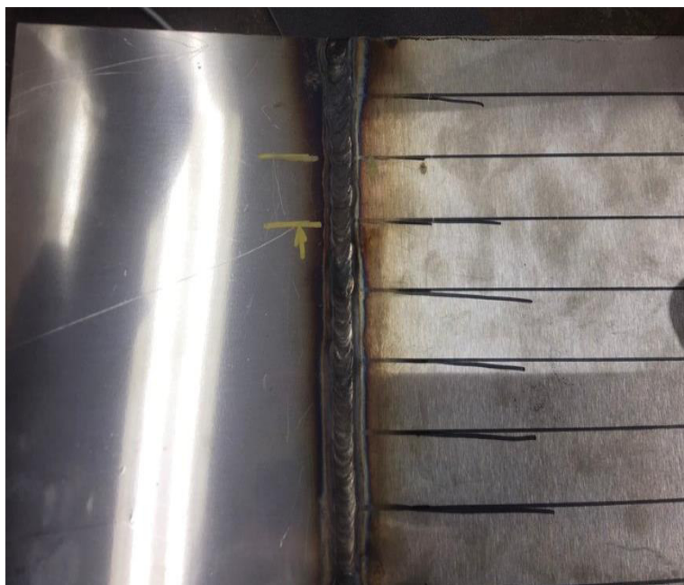
Figura 3.2 Junta soldada para la obtención de probetas según la norma ASTM E8.
