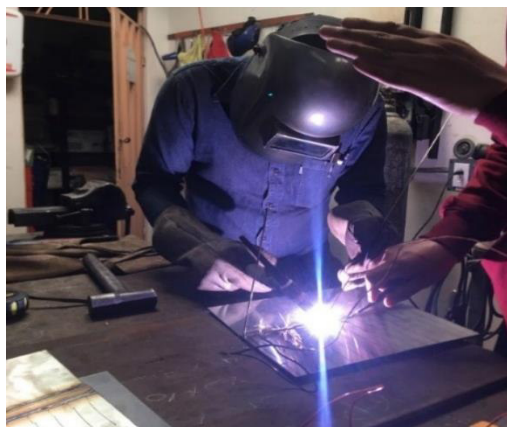
Figura 2.6 Soldando en traslape.
