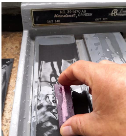
Figura 3.6 Probetas sometidas a desbaste fino.
