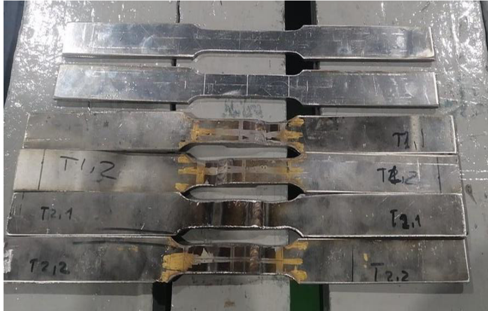
Figura 3.3 Probetas con las dimensiones estándares para aplicar ensayo de tracción.
