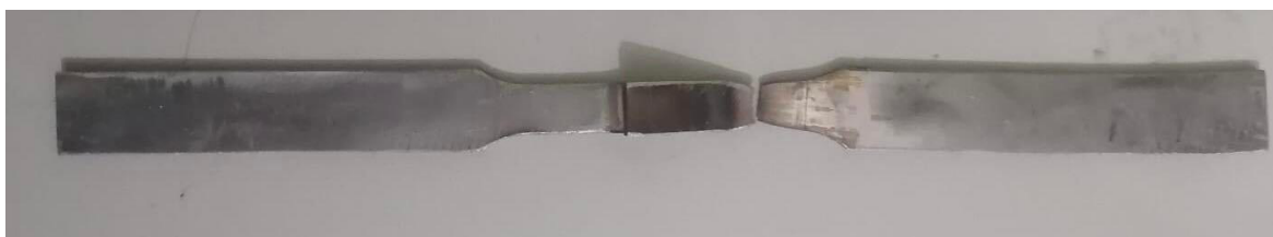
Figura 3.9 Probeta con cordón de soldadura simple después del ensayo de tracción.
