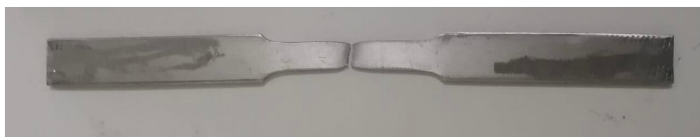
Figura 3.13 Probeta MB1 del material base después del ensayo de tracción.
