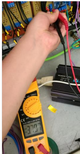
Figura 3.22. Voltaje a la entrada 0 del multiplexor 1 en la prueba 1.
