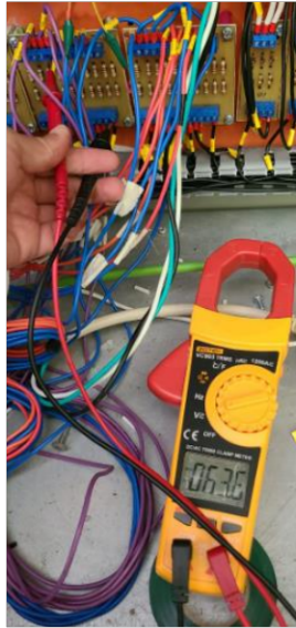
Figura 3.24. Voltaje a la entrada del divisor de voltaje en la prueba 2.
