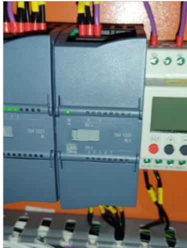
Figura 3.19. Salida en dígito 0 en BCD hacia los multiplexores.
