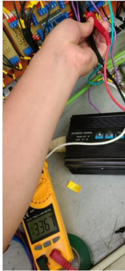
Figura 3.26. Voltaje a la entrada 0 del multiplexor 2 en la prueba 2.
