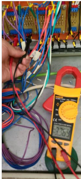
Figura 3.25. Voltaje a la salida del divisor de voltaje en la prueba 2.
