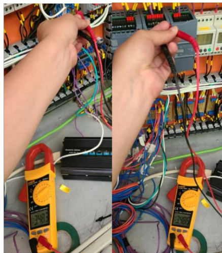
Figura 3.31. Voltaje a la salida del multiplexor 3 en la prueba.
