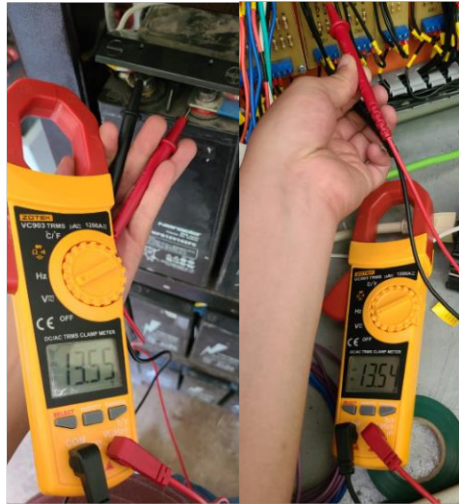
Figura 3.28. Voltaje a los terminales de la batería 1 de 12 V y a la entrada del divisor de voltaje en la prueba 3.
