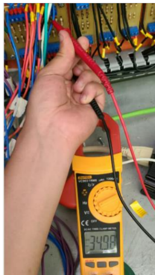
Figura 3.20. Voltaje a la entrada del divisor de voltaje en la prueba 1.
