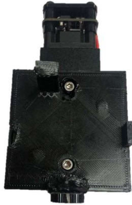
Figura 2.2. Unión entre la base de acople y el cabezal láser.
