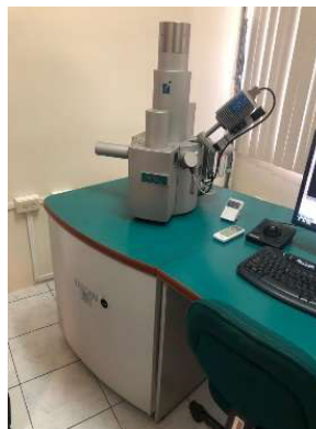
Figura 2.20. Equipo utilizado para la microscopía electrónica de barrido.
