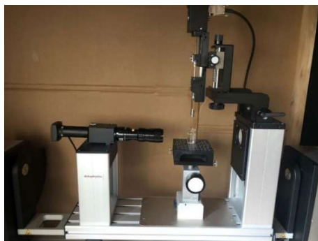
Figura 2.21. Equipo para medición del ángulo de contacto.
