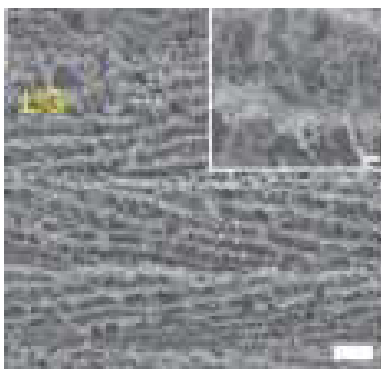
Figura 1.19. Imagen SEM de películas de grafeno poroso obtenido en poliimida con el uso de un láser infrarrojo de CO 2 .
