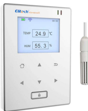
Figura 2.18. Imagen referencial del Termohigrómetro utilizado en el LANUM para la medición de las condiciones ambientales.
