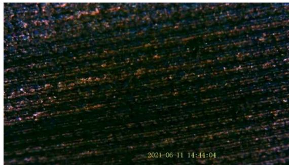
Figura 2.16. Imagen ampliada probeta con parámetros de Potencia máxima=60; Velocidad de corte=400 mm/min; Espacio de exploración=0,05 mm/línea.
