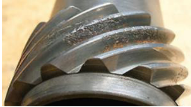
Figura 1.8. Desgaste de la superficie del diente de un engrane. (Miró, 2021)
