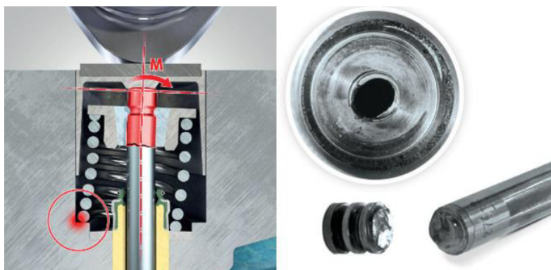
Figura 1.6. Montaje incorrecto de la válvula del motor de un automóvil. (Rheinmetall, 2021)
