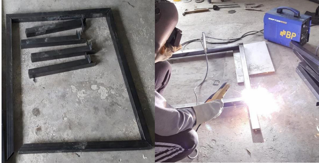
Figura 2.6 Ensamblaje de la estructura del módulo.
