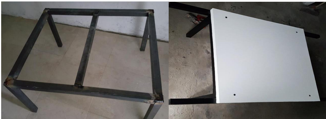
Figura 3.2 Resultado final del ensamblaje de la estructura soporte.
