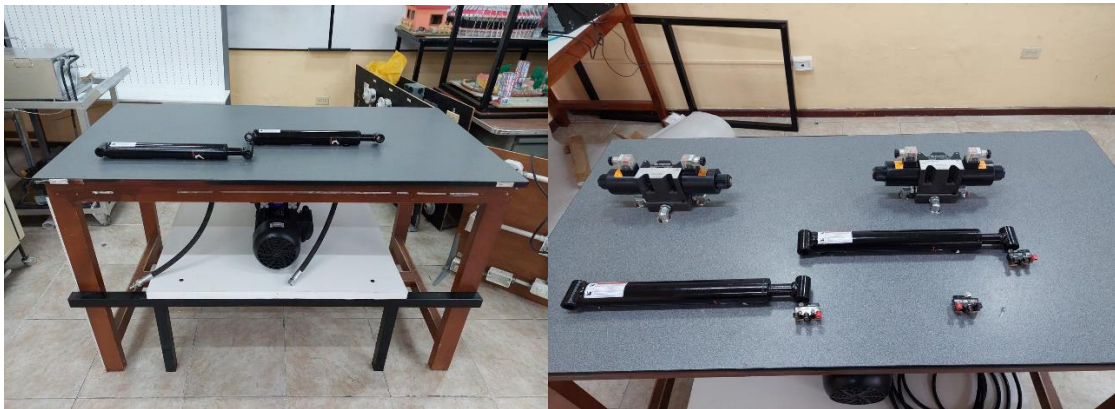
Figura 2.9 Ensamblaje electroválvulas del sistema hidráulico.
