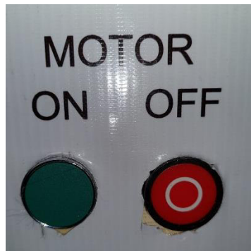
Figura 3.5 Botones marcha paro de la unidad hidráulica.
