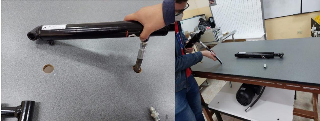
Figura 2.8 Ensamblaje actuadores del sistema hidráulico.
