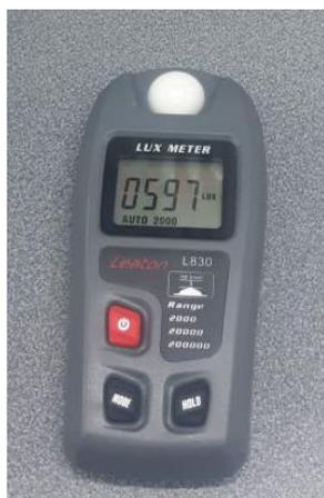
**Figura 3.9.** Medición con el luxómetro
