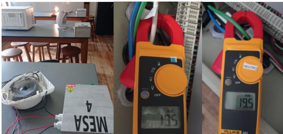
Figura 3.8 Medición de corriente en la línea R y en el neutro respectivamente.
