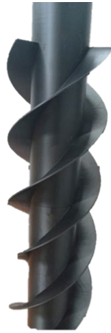
Figura 2.10 Hidro tornillo final fabricado .
