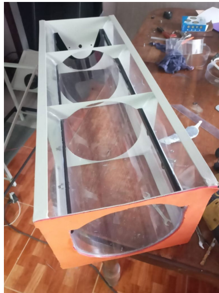
Figura 2.13 Fijación del canal plástico mediante platinas.
