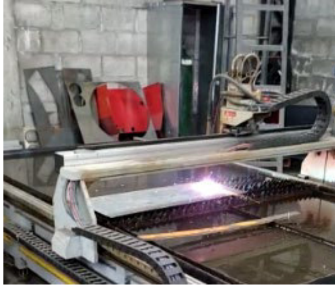
Figura 2.12 Corte de placas mediante plasma .
