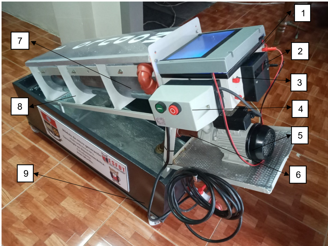
Figura 3.1 Módulo de micro generación hidroeléctrico finalizado.
