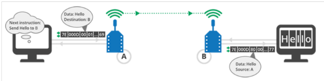
Figura 2.13. Comunicación en modo API. (Fuente: [44])
