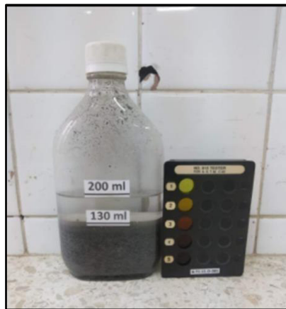
Figura 2.5. Botella con agregado y solución de hidróxido de sodio
