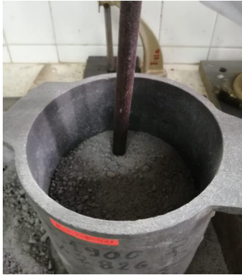
Figura 7.10. Compactado de la arena en el recipiente.
