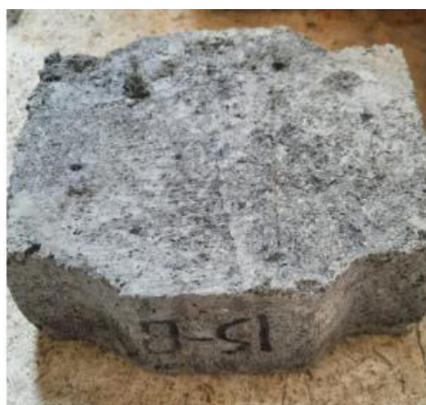
Figura 3.6. Adoquín con 15% de residuos peligrosos.
