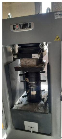
Figura 2.9. Rotura de adoquines.
