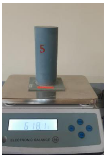
Figura 7.6. Peso del cemento compactado.
