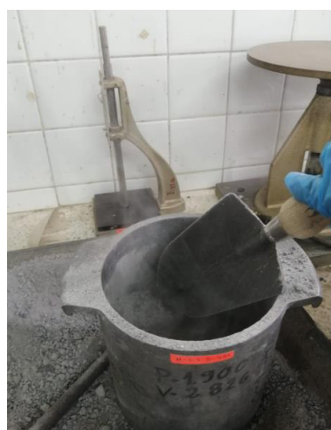
Figura 7.9. Llenado del recipiente cilíndrico.
