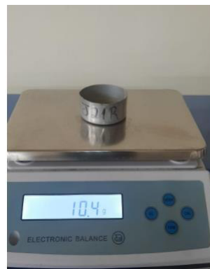
Figura 7.14. Ensayo de contenido de humedad de los residuos peligrosos.
