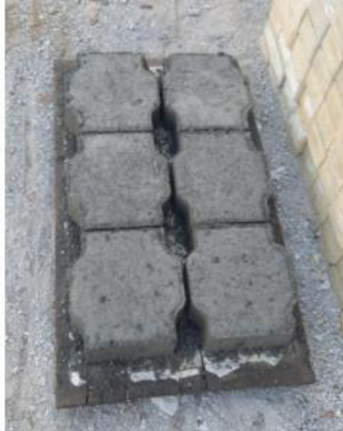
Figura 2.6. Secado de adoquines.
