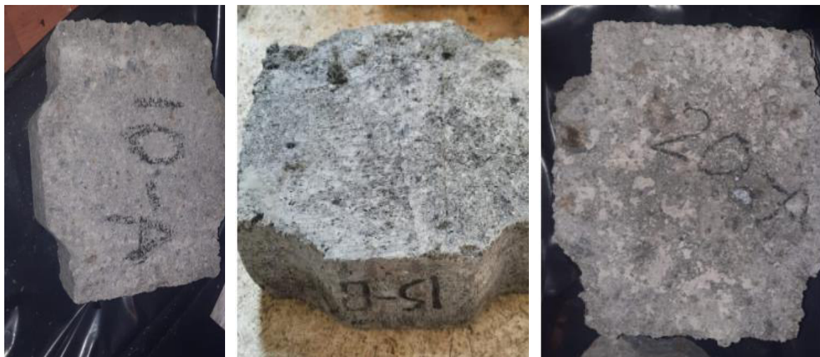
Figura 2. Acabados de los adoquines con 10, 15 y 20%.
