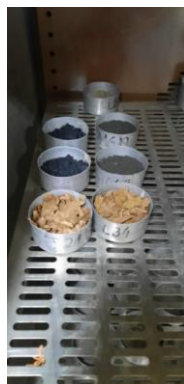
Figura 7.14. Ensayo de contenido de humedad de los residuos peligrosos.
