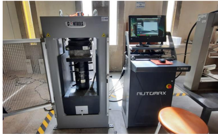
Figura 2.10. Prueba de resistencia a la compresión en adoquines.
