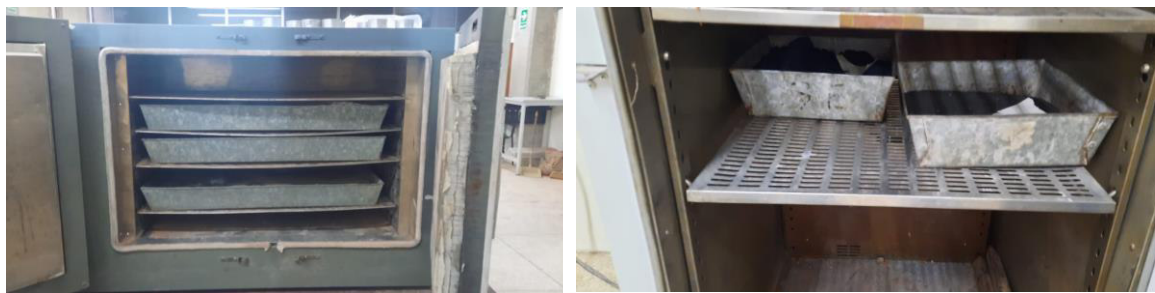
Figura 7.5. Secado de la arena y residuos peligrosos.
