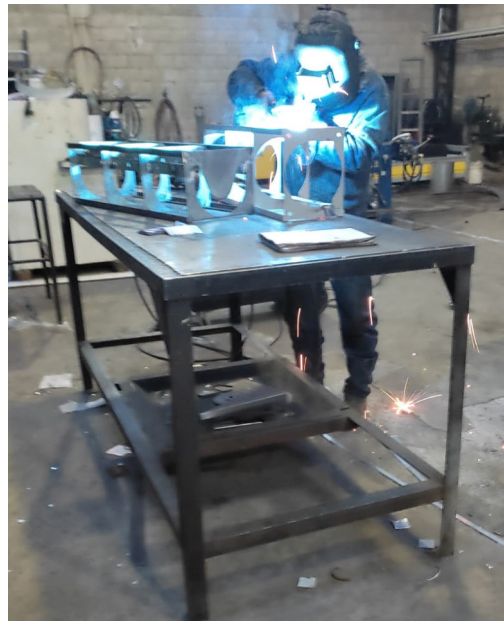
Figura 2.10 Proceso de soldadura de la base con MIG.
