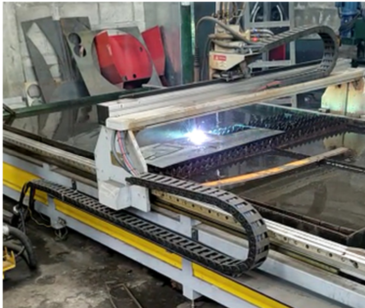
Figura 2.9 Proceso de corte con plasma.
