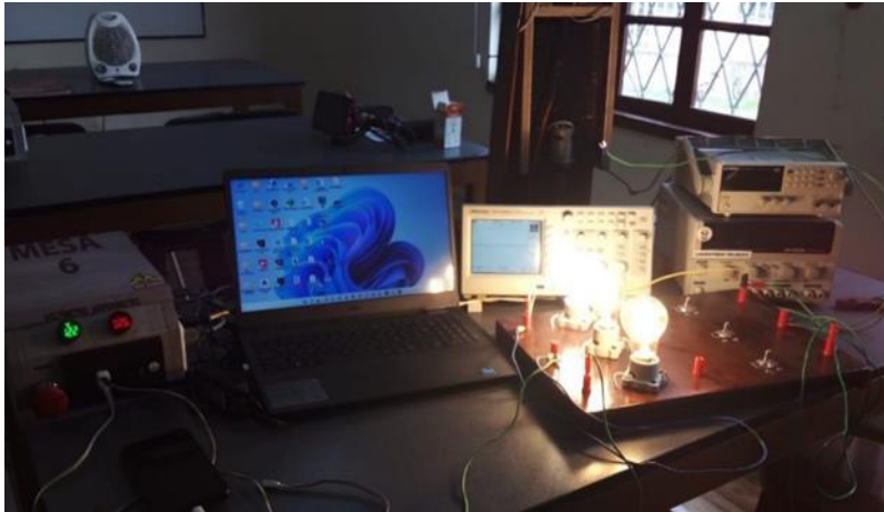
Figura 3.5 Prueba de caída de tensión con una potencia total de 636 (W).
