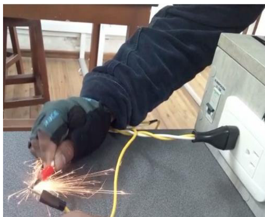
Figura 3.7 Prueba de cortocircuito
