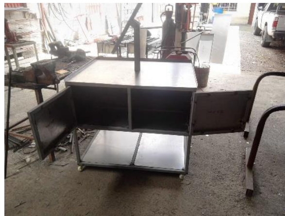
Figura 2.14 Armazón de la estructura e instalación del tol.
