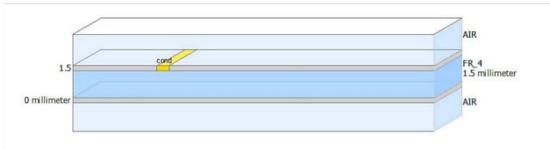
Figura 2.3 Ambiente simulado de la antena fractal de Vicsek: aire-sustrato FR4-aire.
