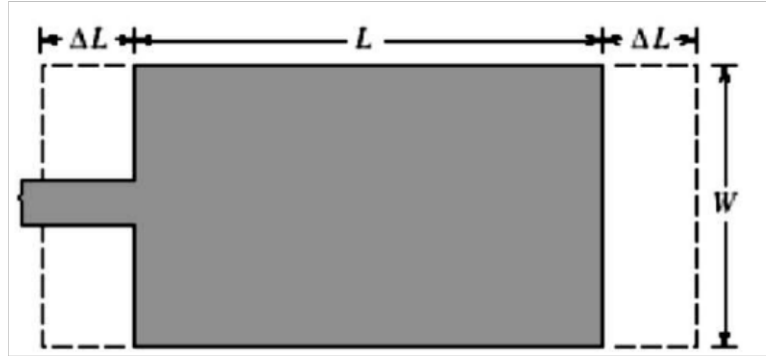
Figura 2.1 Dimensiones del parche rectangular a ser calculadas [14].
