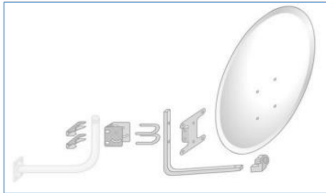
Figura 2.13. Ensamblaje de la antena Offset [15].
