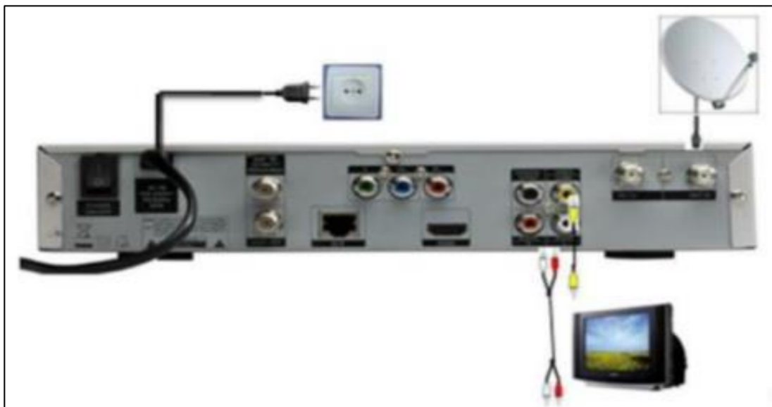
Figura 2.16. Conexión del decodificador [10].
