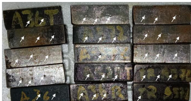
Figura 2.27. Marcas dejadas por el indentador
