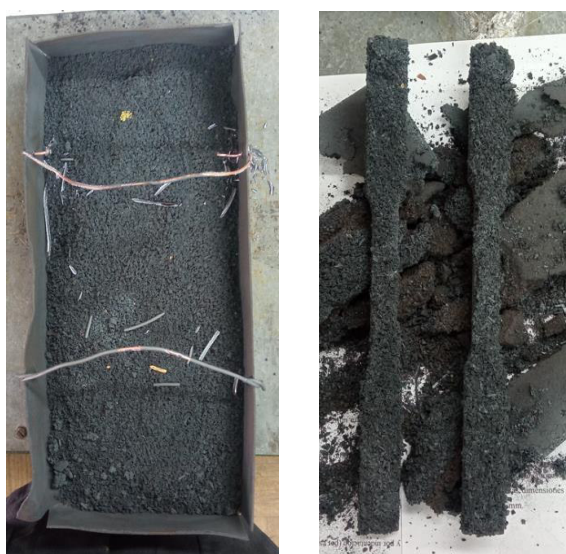
Figura 2.10. Probetas recocidas extraídas de la caja
