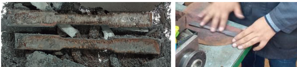
Figura 2.11. Limpieza de las probetas con papel de carburo de silicio de 400 o 600 granos por pulgada cuadrada (Fuente: propia)
