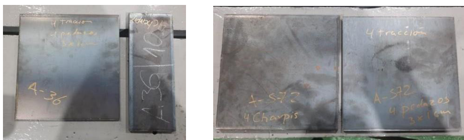
Figura 2.1. Placas de acero de donde se extrajeron las probetas (Fuente: propia)
