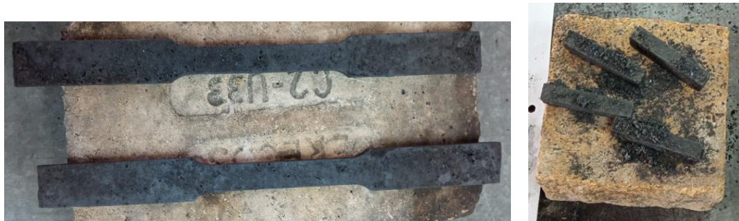
Figura 2.15. Probetas templadas extraídas de la caja con limalla (Fuente: propia)
