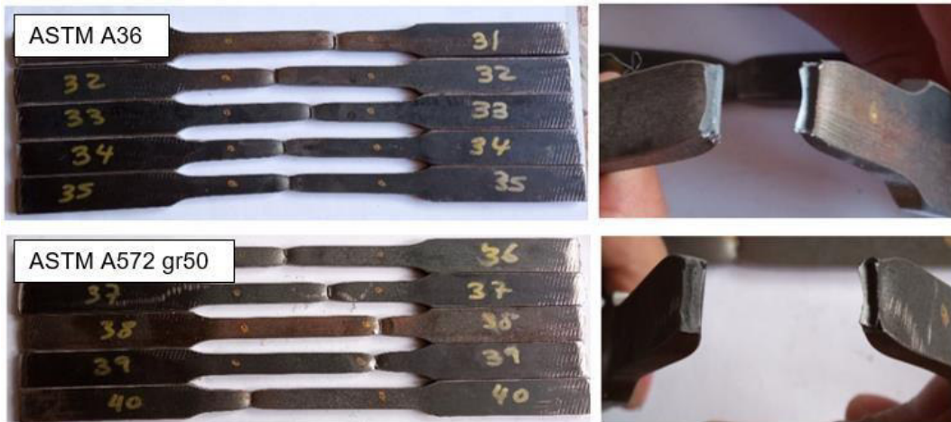
Figura 3.6. Probetas testigo utilizadas en el ensayo de tracción (Fuente: propia)
