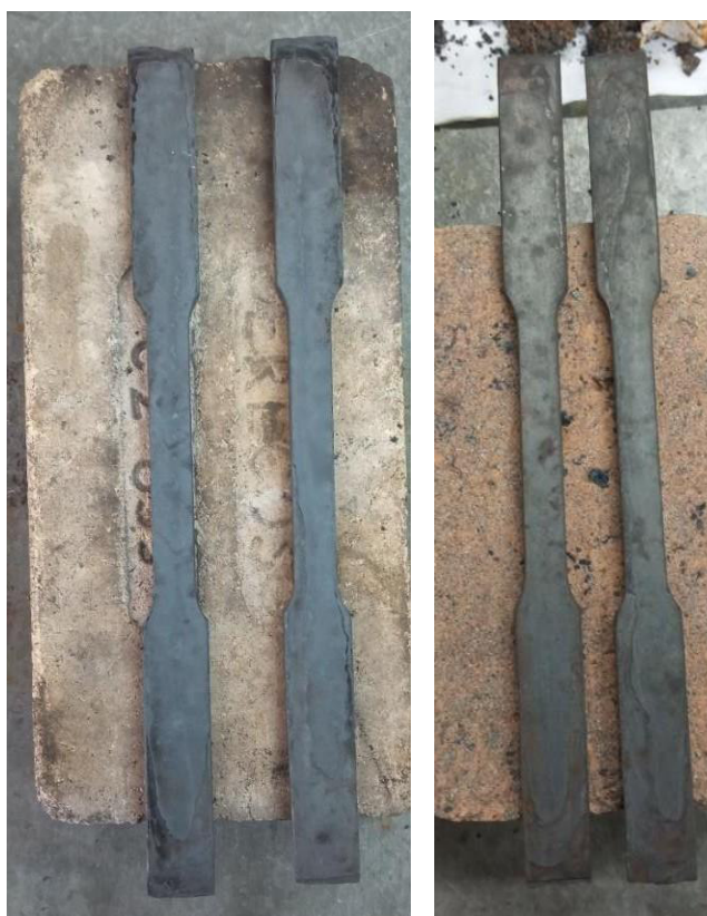
Figura 3.5. Probetas templadas y revenidas para ensayo de tracción
