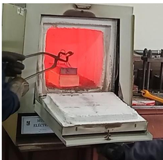
Figura 2.12. Extracción de la probeta (Fuente: propia)
