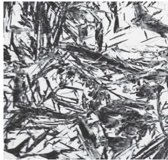
Figura 1.27. Estructura martensítica después del temple (Fuente: [6])
