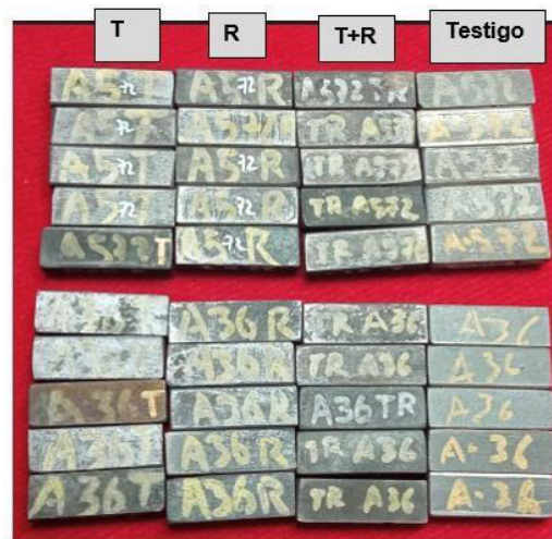
Figura 2.18. Probetas para ensayo de dureza identificadas (Fuente: propia)
