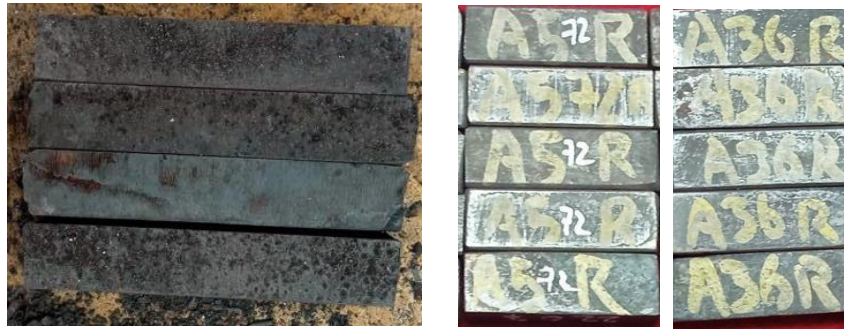
Figura 3.2. Probetas recocidas para ensayo Charpy y dureza (Fuente: propia)
