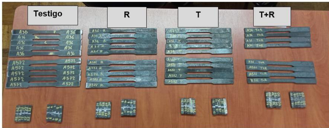
Figura 2.17. Probetas de ensayo de Tracción y ensayo Charpy identificadas (Fuente: propia)
