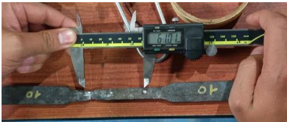
Figura 2.25. Medición de la longitud libre después de la prueba (Fuente: propia)
