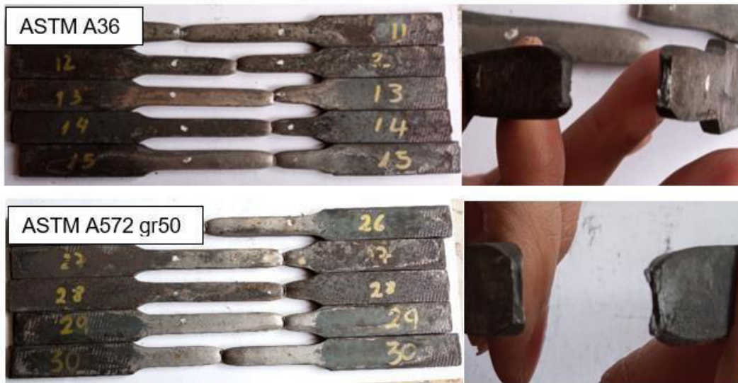
Figura 3.12. Probetas para ensayo de tracción templadas y revenidas (Fuente: propia)
