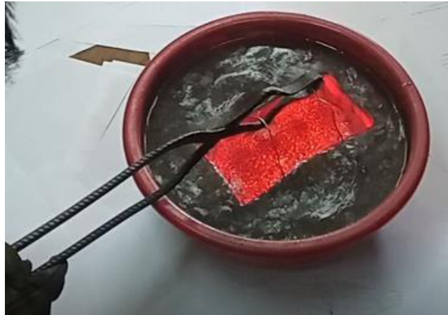
Figura 2.13. Enfriamiento en agua (Fuente: propia)
