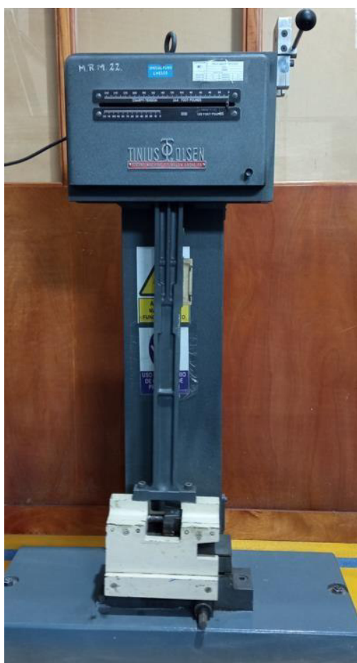
Figura 2.28. Máquina universal para el ensayo Charpy (Fuente: propia)
