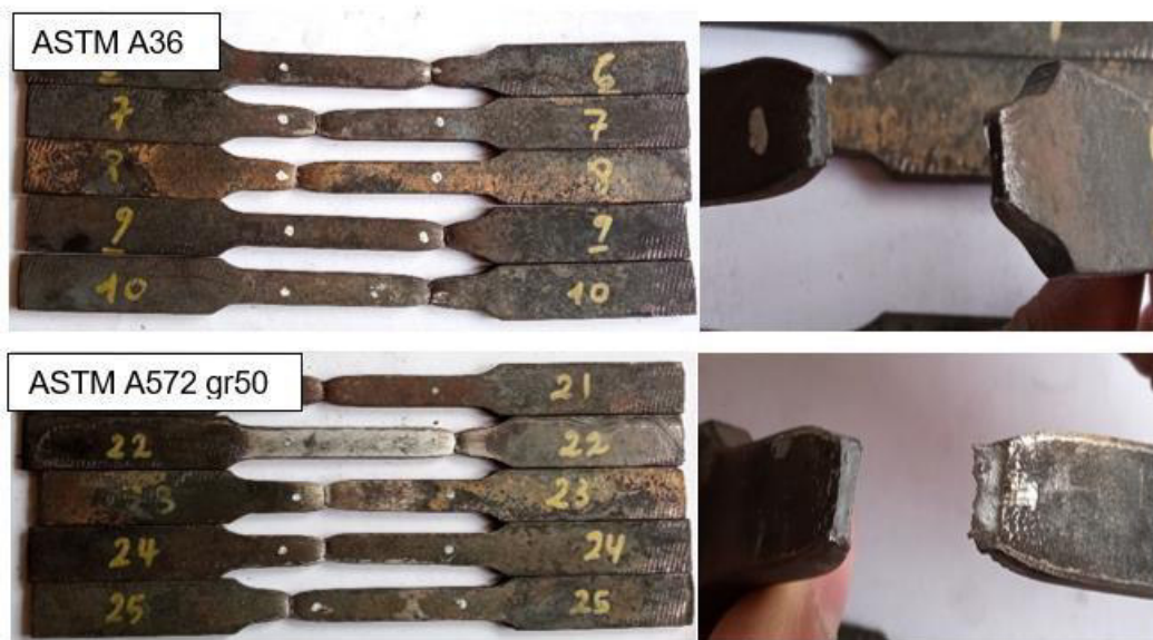
Figura 3.10. Probetas para ensayo de tracción templadas (Fuente: propia)
