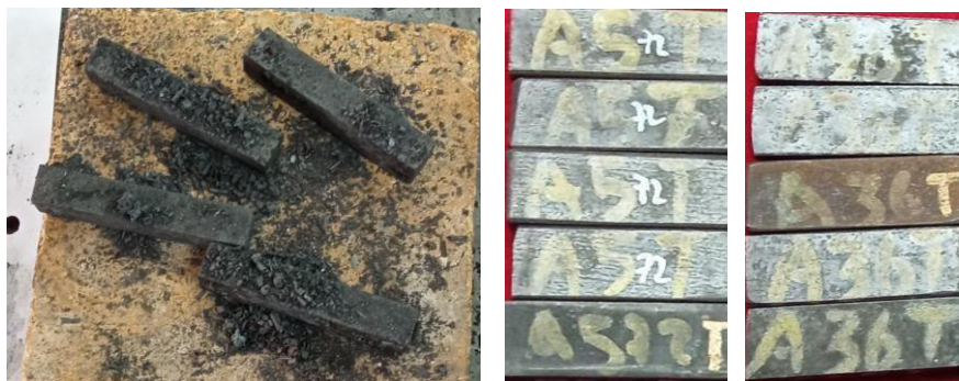
Figura 3.4. Probetas templadas para ensayo Charpy y dureza
