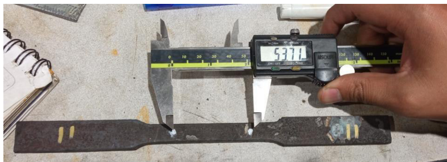
Figura 2.24. Medición de la longitud libre antes de la prueba (Fuente: propia)
