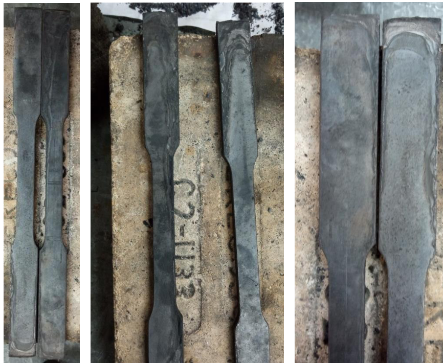
Figura 3.3. Probetas templadas para ensayo de tracción (Fuente: propia)
