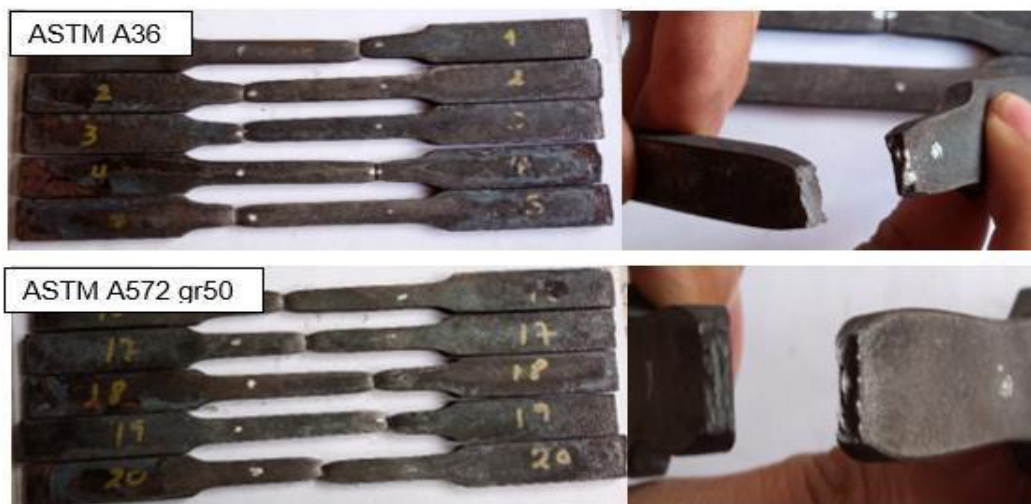
Figura 3.8. Probetas para ensayo de tracción recocidas (Fuente: propia)
