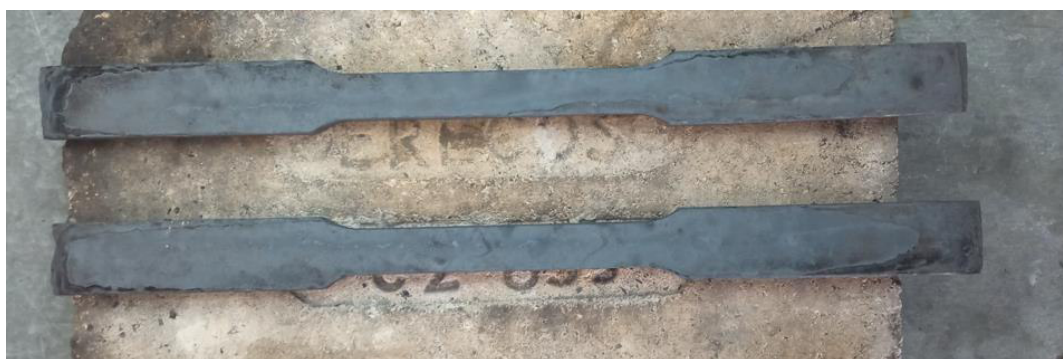
Figura 2.16. Probetas revenidas enfriadas al aire (Fuente: propia)
