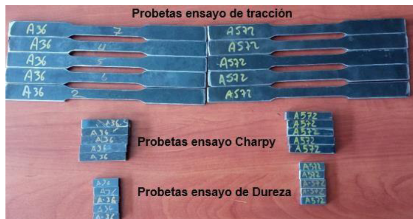
Figura 2.4. Probetas extraídas del material base
