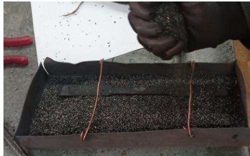
Figura 2.8. Cubrimiento de las probetas con limalla (Fuente: propia)
