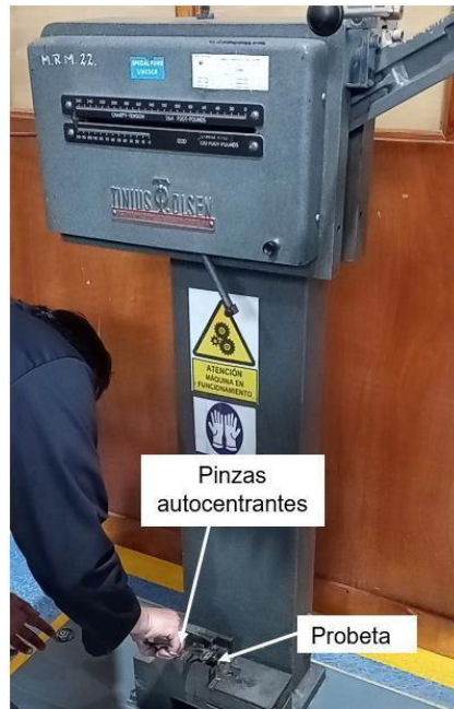
Figura 2.29. Colocación de las probetas (Fuente: propia)
