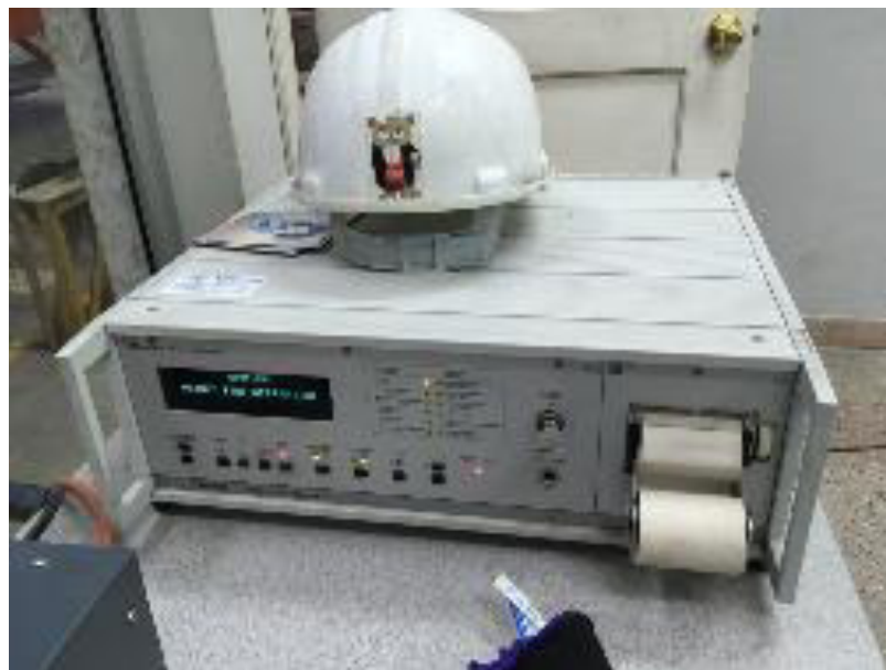
Figura 26. Sistema múltiple de medición UPM 100. Elaboración: Jorge Martínez y Darío Pallares
