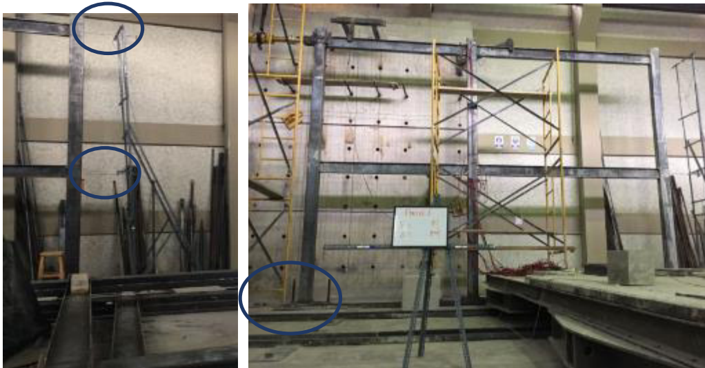
Figura 35. Ubicación de transductores de desplazamiento. Elaboración: Jorge Martínez y Darío Pallares
