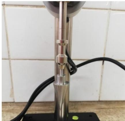
**Figura 33.** Cono de acero inoxidable del laboratorio LEMSUR
