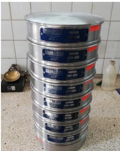
**Figura 3.** Conjunto de tamices para una prueba de laboratorio
