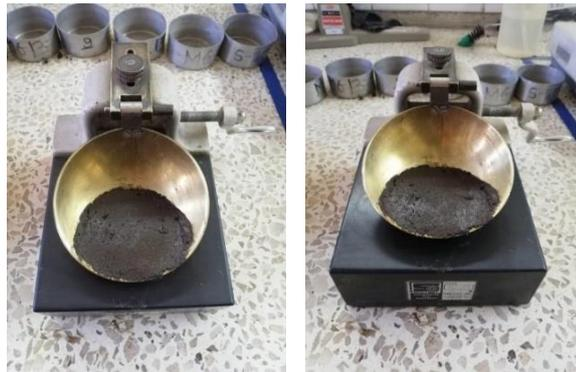
**Figura 29.** Colocación de la muestra en la Copa de Casagrande
