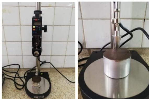
**Figura 38.** Ajuste del cono con la superficie de la muestra
