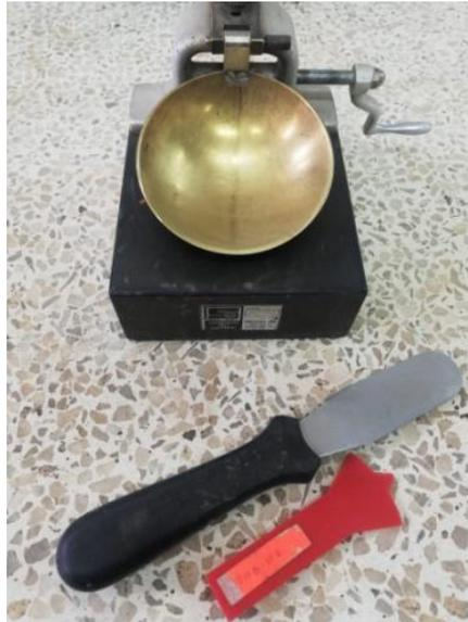
**Figura 27.** Equipo utilizado en el ensayo de Copa de Casagrande
