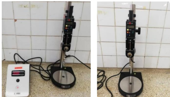
**Figura 13.** Penetrómetro Cónico Laboratorio LEMSUR
