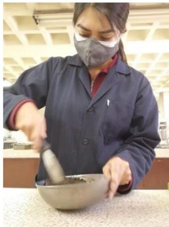
**Figura 40.** Preparación de la muestra para ensayo de límite plástico
