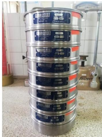
**Figura 50.** Tamices utilizados en el laboratorio “LEMSUR”
