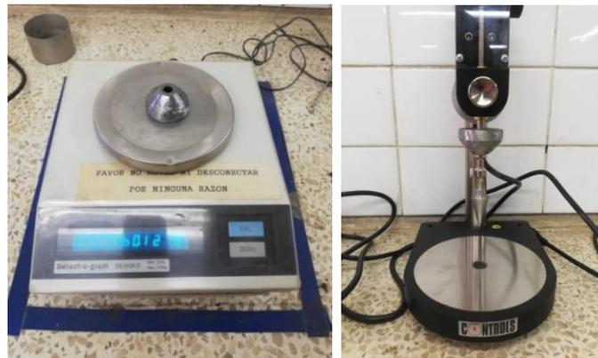
**Figura 45.** Peso añadido al cono del penetrómetro cónico
