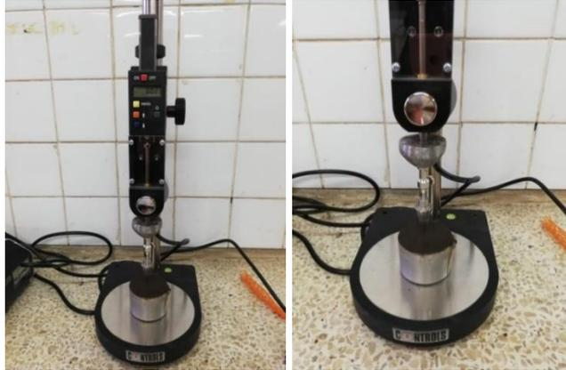
**Figura 47.** Ajuste de la superficie de la muestra con el cono
