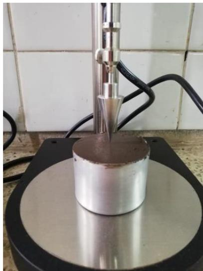
**Figura 46.** Superficie enrasada para ensayo de límite plástico
