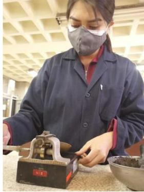
**Figura 31.** Ejecución del ensayo de Copa de Casagrande
