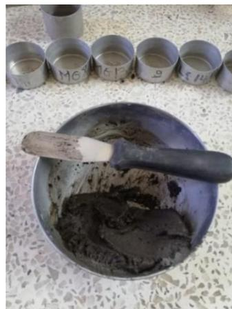
**Figura 28.** Preparación de la mezcla para ensayo de Copa de Casagrande
