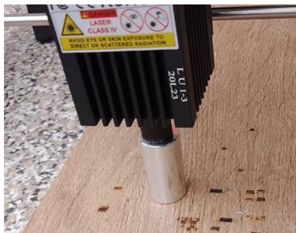
Figura 2.2. Barra de aluminio usada para ajustar el diámetro del haz de luz del láser.
