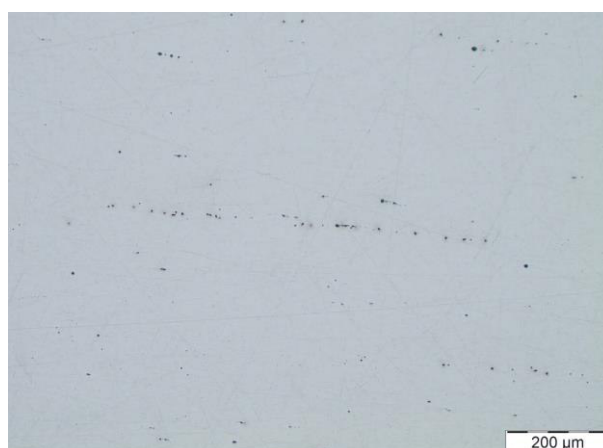
Figura 3.2 Análisis superficial de la probeta sin ataque químico (200X). (Fuente: Propia-2022)
