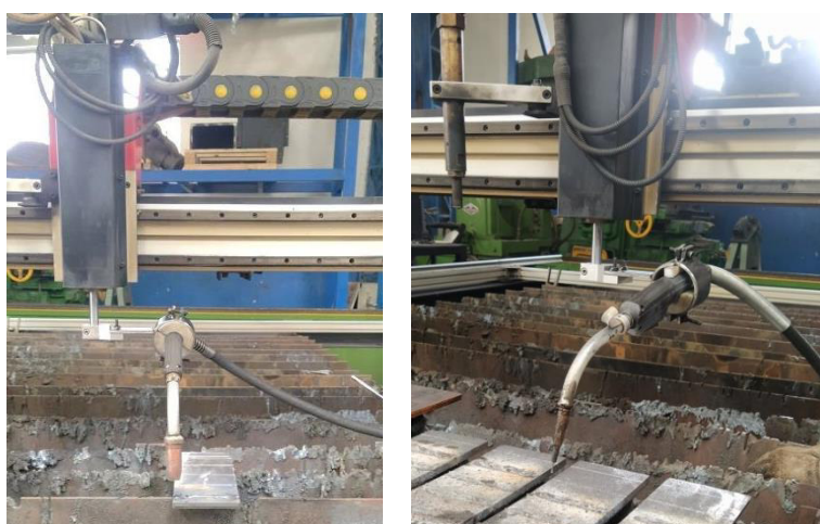
Figura 2.3 Ajuste para acople de antorcha de soldadura en máquina de corte CNC
