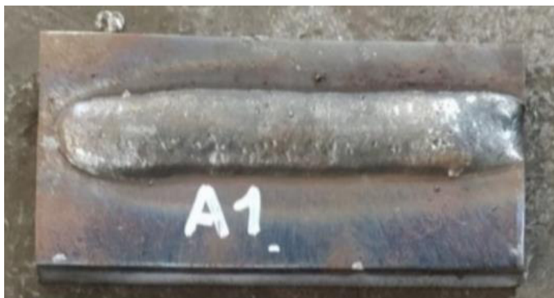
Figura 3.5 Deposito sobre placa A1 a velocidad de alimentación de 169,33 [mm/s]. (Fuente: Propia, 2022)
