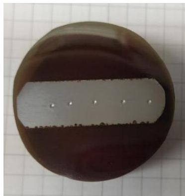
Figura 3.4 Probeta 22-004-P-01 ensayada para determinar dureza (Fuente: Propia- 2022)
