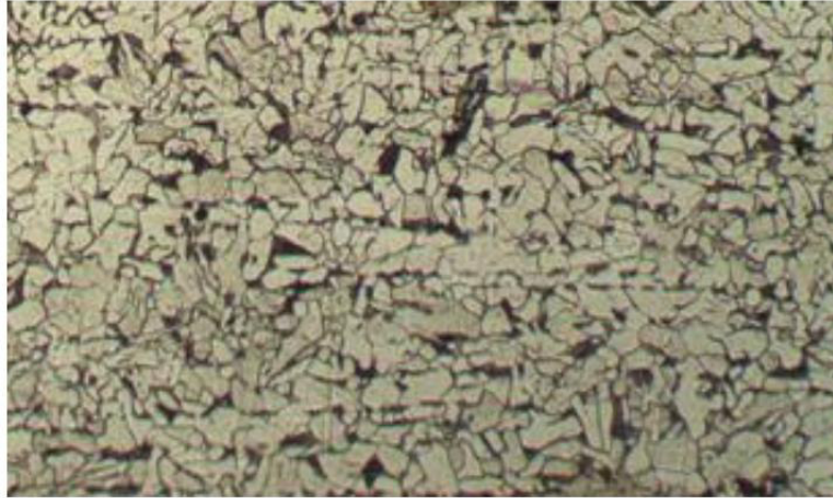
Figura 1.7 Metalografía del acero A36 Fuente: Naranjo, C., Sánchez, X., & Tobar, E. -2015.
