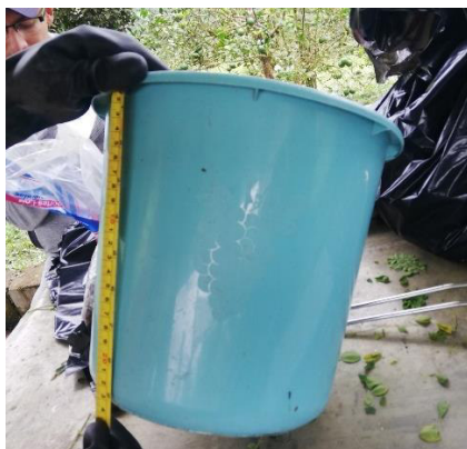
Figura 14. Medición de las dimensiones del balde usado en el pesaje de RSO
