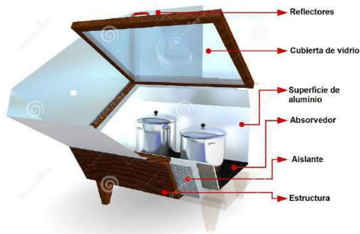
Figura 1.5 Partes de horno solar
