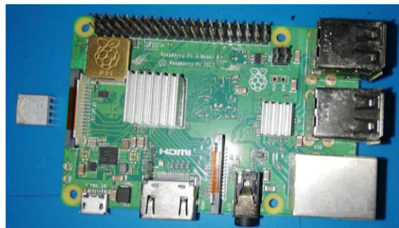
Figura 3.12 Instalación de disipadores
