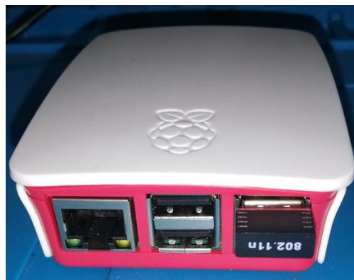
Figura 3.28 Instalación de la tarjeta de red inalámbrica
