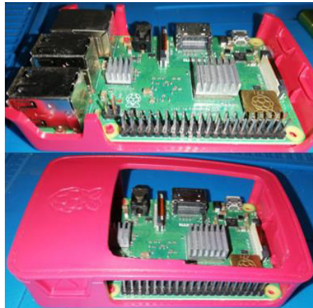
Figura 3.13 Instalación del case protector
