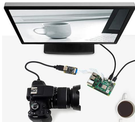
Figura 1.3 Funcionamiento del adaptador HDMI a CSI [12]
