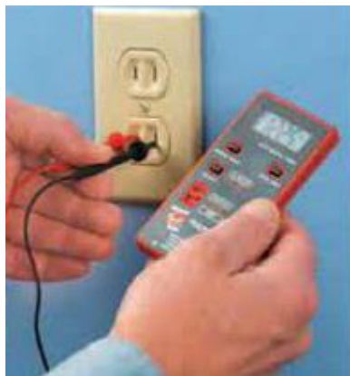
Figura 2.28 Inspección del tomacorriente, [7].
