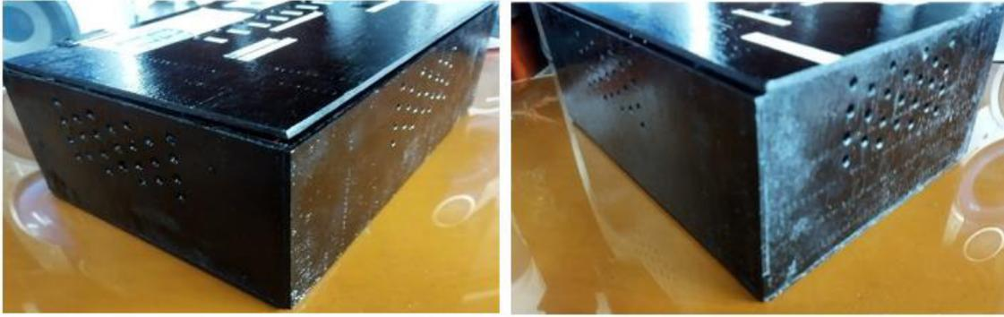
Figura 3.56 Ranuras de ventilación
