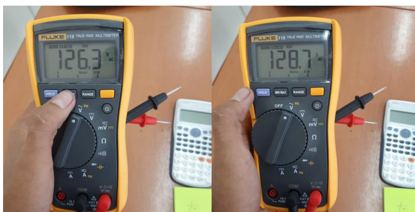
Figura 2.1 Verificación de entrega de voltaje en tomas.
