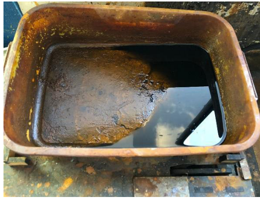
Figura 3.13 Recipiente con mezcla de cloruro férrico y agua
