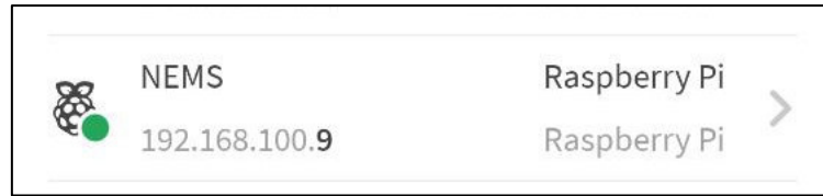
Figura 3.8 Obtención de la dirección del dispositivo Raspberry Pi con la herramienta FING
