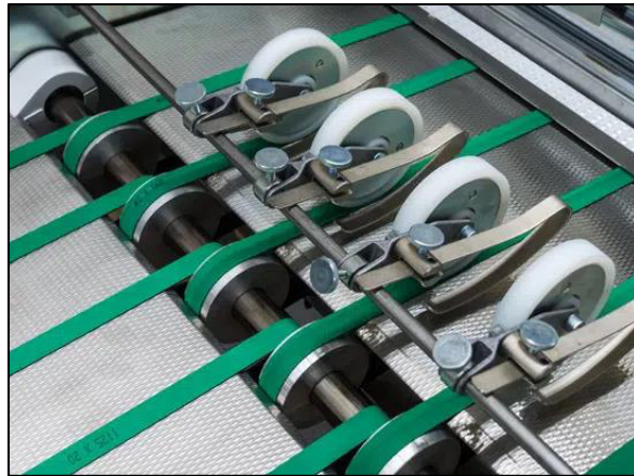
Figura 1.8 Uso de bandas y poleas en la industria, [8].
