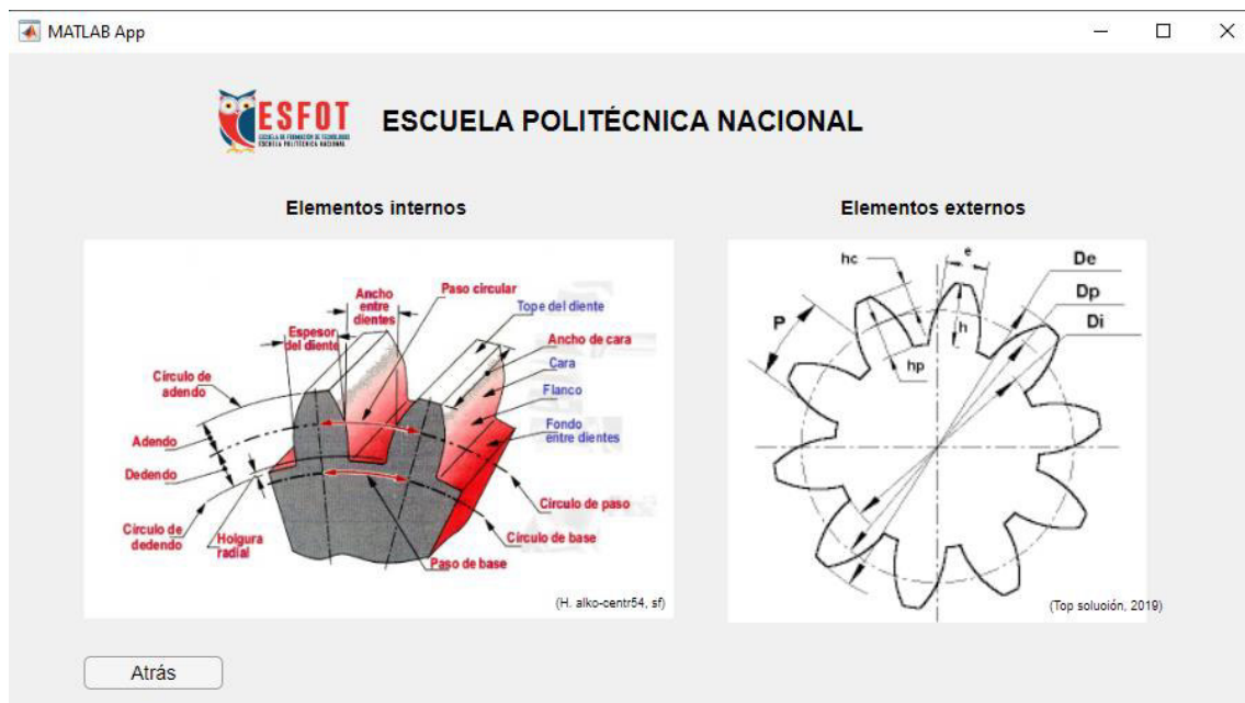
Figura 2.22. Elementos de un engrane recto.
