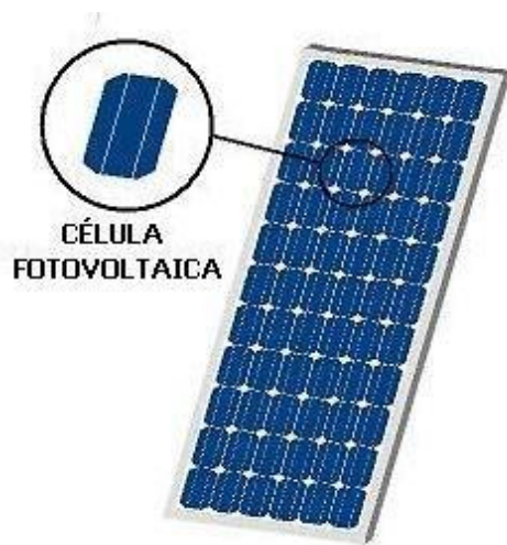
Figura 1.1. Composición de un módulo fotovoltaico
