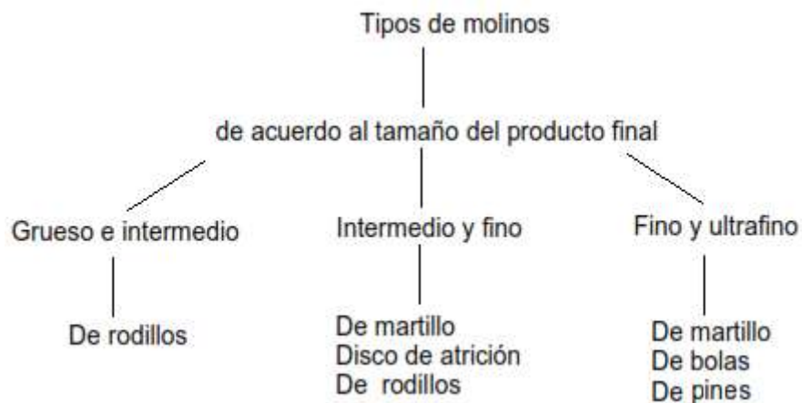
Figura 1. Clasificación de los molinos según el tamaño del producto final.
