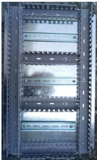
Figura 2.12 Estructura metálica con la distribución de canaletas y riel DIN.
