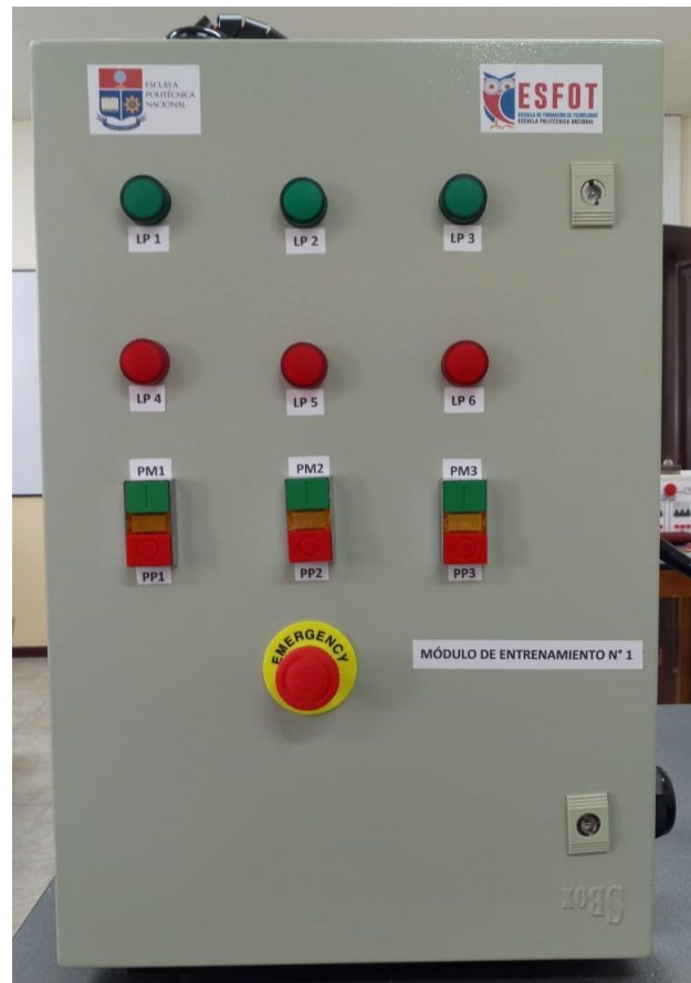
Figura 2.16 Distribución de elementos de mando y luces piloto en el exterior.
