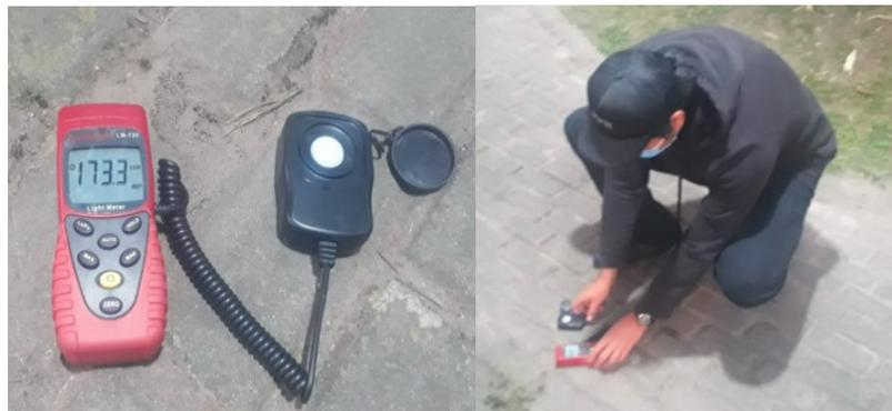
**Figura 2.3.2** Medición de luxes en la ESFOT.
