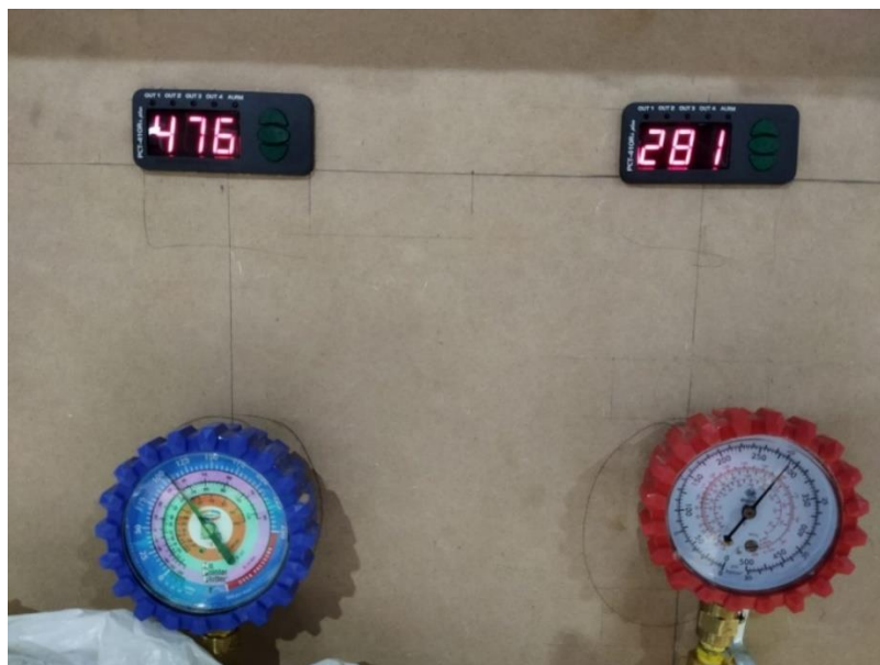
Figura 2.20 Presión de presurización en la línea de alta y baja (11 de julio)
