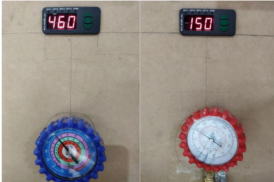
Figura 2.23 Presión de presurización en la línea de alta y baja (14 de julio)
