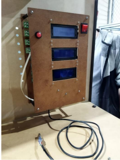
Figura 3.3 Sensores temperatura voltaje y corriente en Arduino
