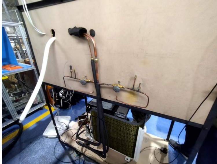
Figura 2.11 Ensamblaje del sistema de refrigeración
