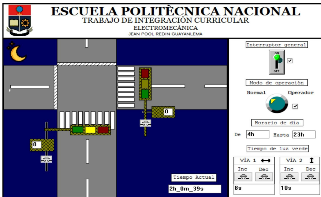
Figura 3.6. Prueba de funcionamiento Modo noche a las 02h00
