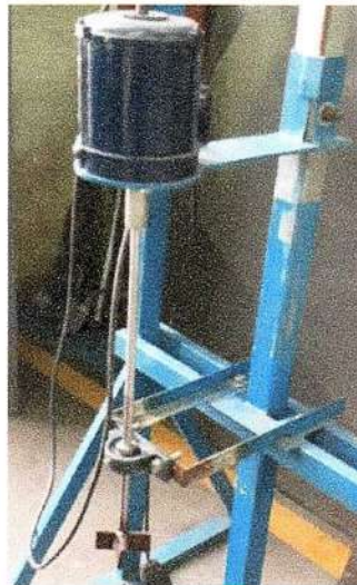
Figura 2.10. Montaje del eje de acero con el agitador después de la obtención del FGM. [Fuente: propia].
