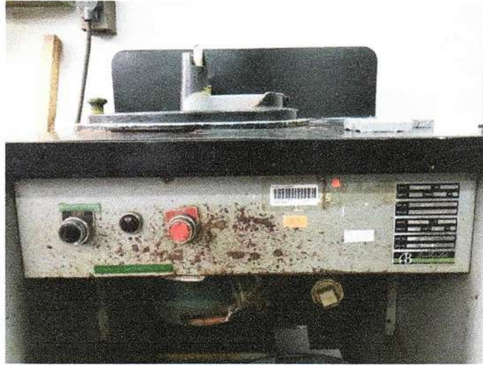
Figura 2.15. Máquina pulidora del laboratorio de Metalografía, Desgaste y Falla.
