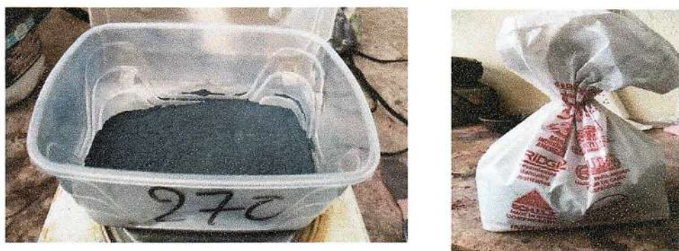
Figura 1.3. Partículas cerámicas #400 coloración negra.
