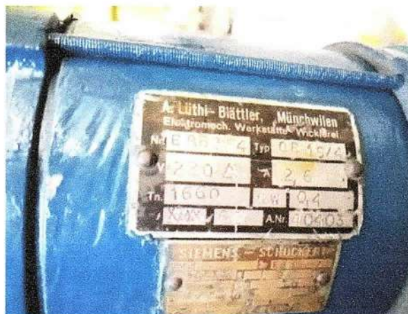
Figura 2.8. Placa de datos del motor eléctrico de la máquina stir casting.
