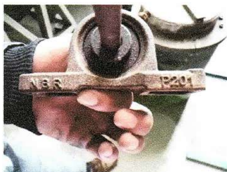
Figura 2.11. Eje y chumacera con superficie corroída.
