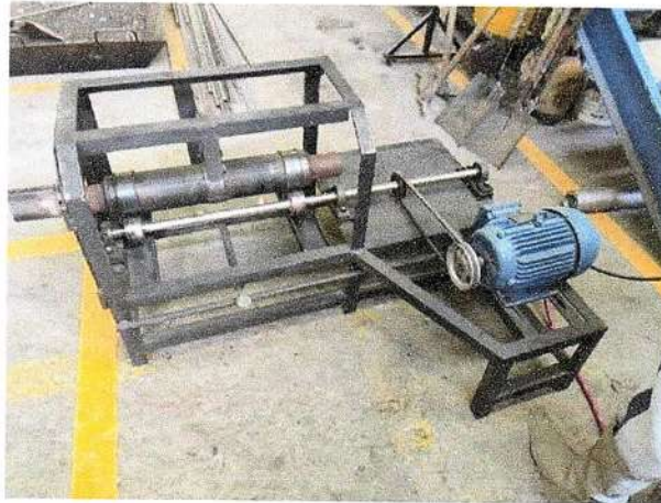
Figura 2.3. Máquina de colado horizontal por fuerza centrífuga. [Fuente: propia].
