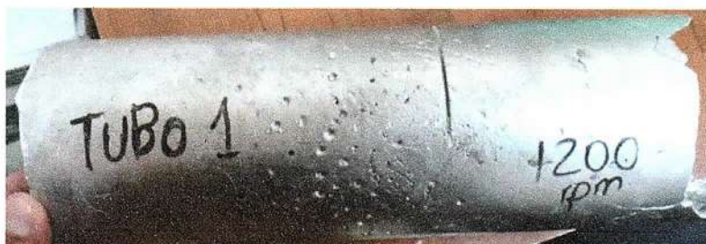
Figura 3.1. Tubo FGM obtenido mediante colado por fuerza centrífuga. [[Fuente: propia].
