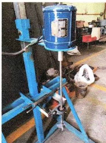
Figura 2.13. Equipo stir casting utilizado para la dispersión de las partículas en la colada de fundición.
