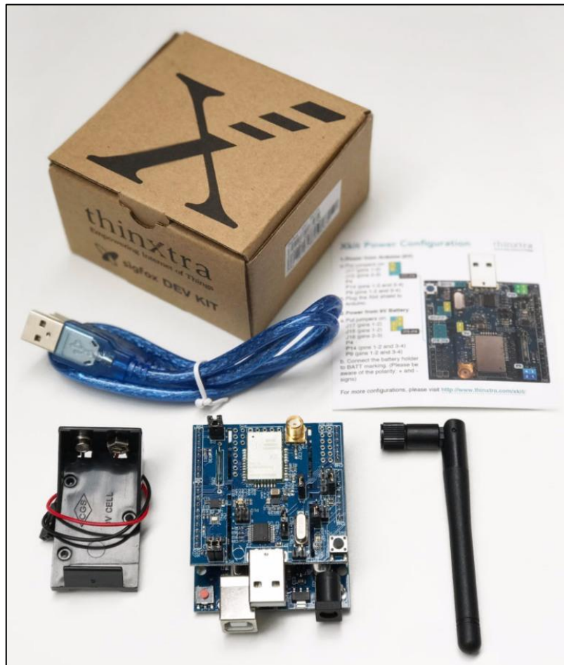
Figura 2.4. Thinxtra Sigfox Dev Kit con todos sus elementos [41]
