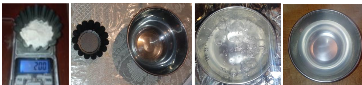
Figura 35. Método de prueba para determinar la solubilidad de la matriz polimérica a partir de almidón de achira. Fuente: propia.
