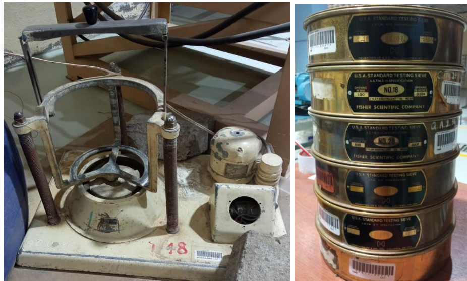
Figura 16. Tamiz y tamizadores del Laboratorio de Operaciones Unitarias, EPN.
