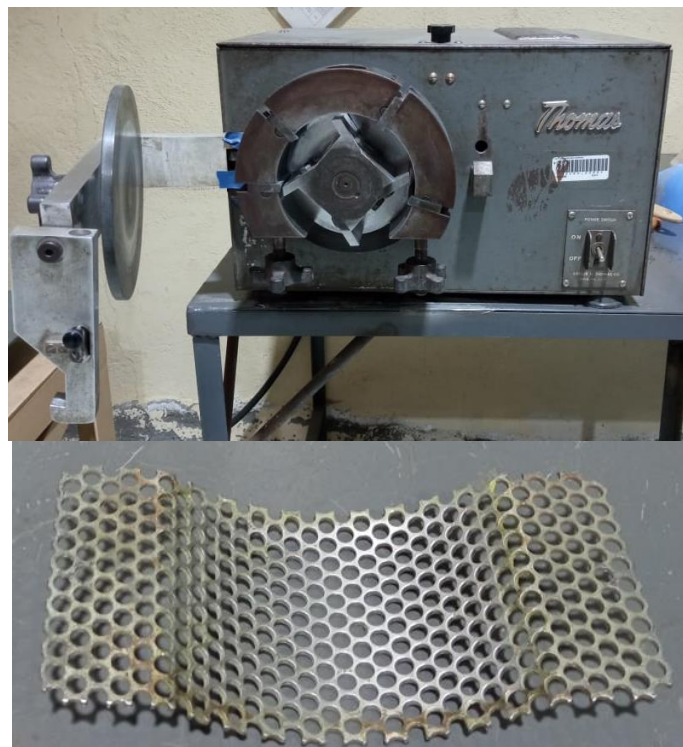
Figura 15. Molino de cuchillas y malla utilizada del Laboratorio de Operaciones Unitarias, EPN. Fuente: Propia
