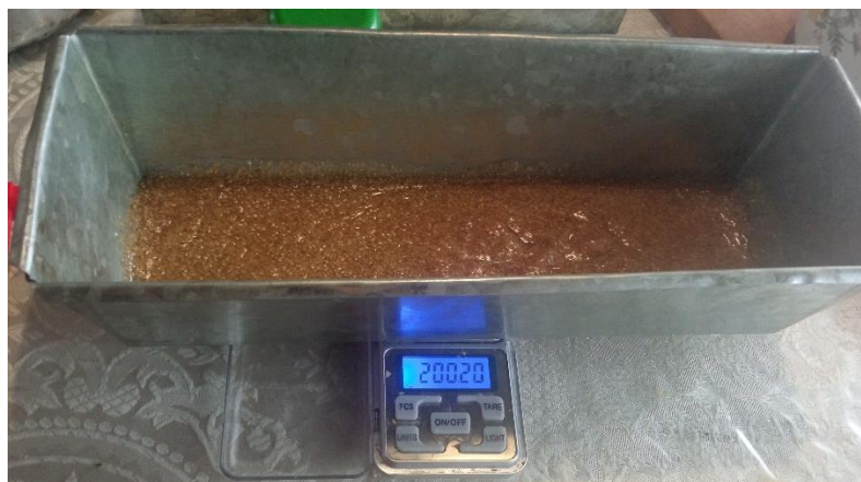
Figura 22. Molde de acero galvanizado para obtener probetas con dimensiones estandarizadas. Fuente: propia.
