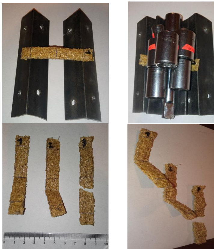
Figura 38. Pruebas de flexión con dos apoyos y una carga puntual. Fuente: propia.
