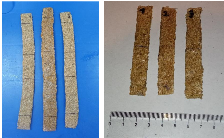
Figura 36. Probetas con dimensiones estandarizadas de tracción y flexión.
