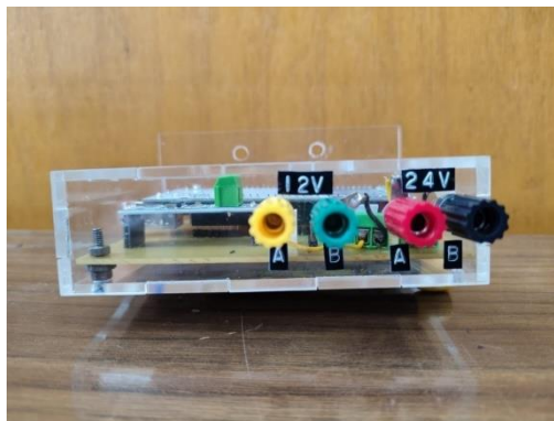
Figura I.2. Borneras de alimentación
