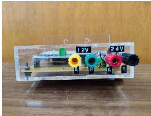
Figura 3.5. Borneras de alimentación
