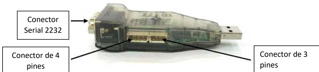
Figura 2.2. Estructura del módulo USB2-Dynamixel [2]
