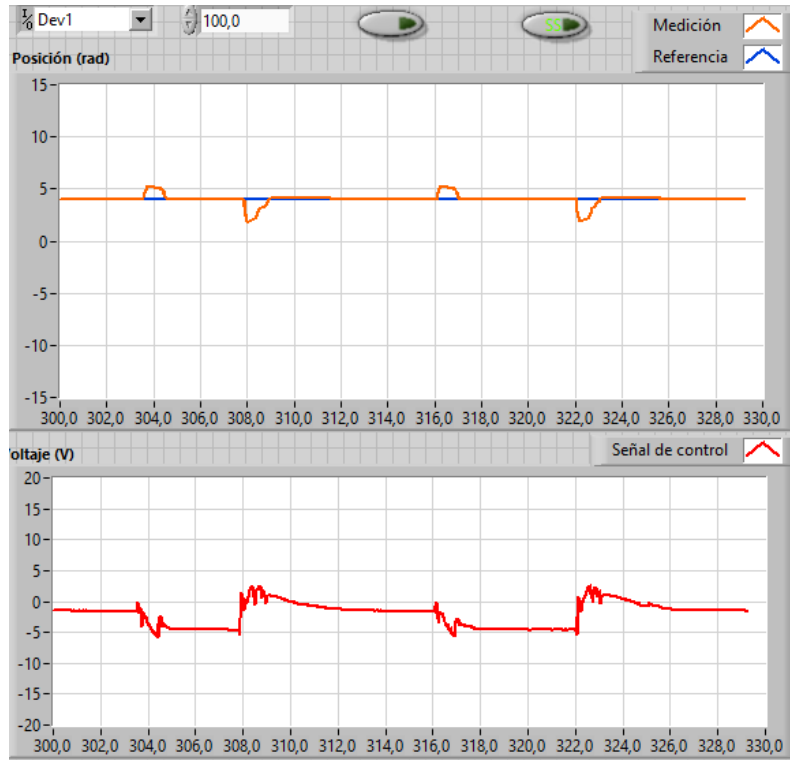
Figura 3.25. Respuesta del sistema y señal de control ante perturbaciones constantes en la señal de control con el esquema en Espacios de Estado
