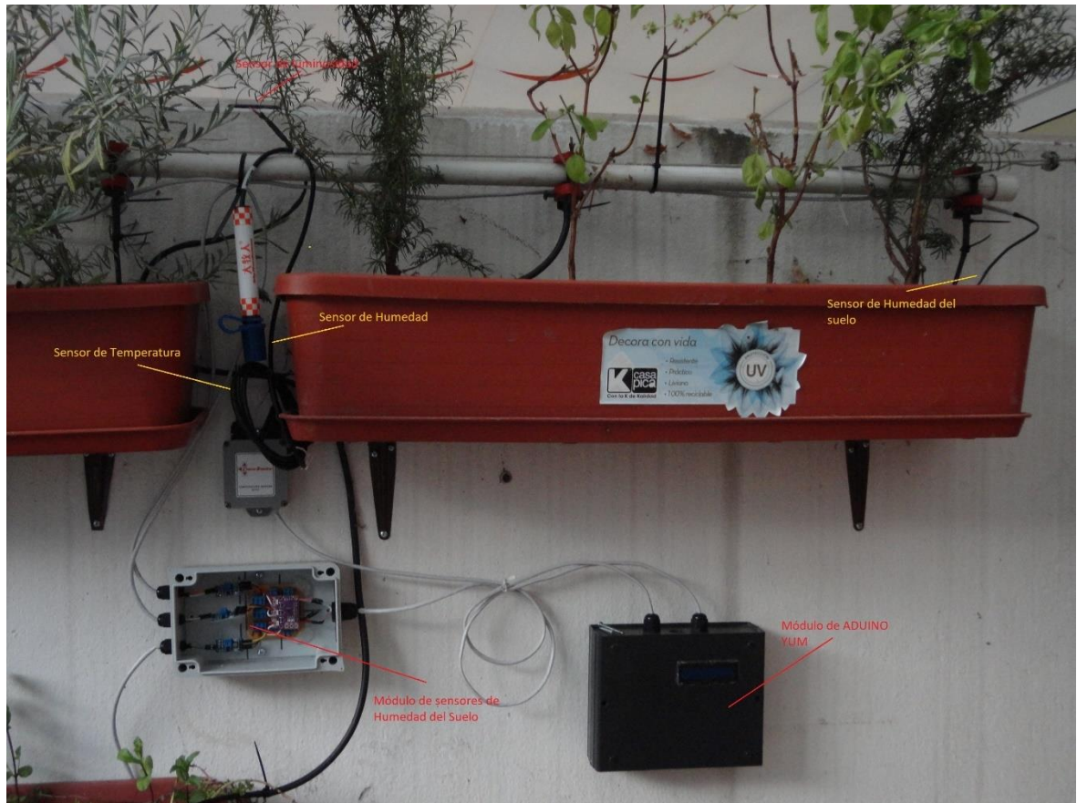
Figura 3.18. Sistema de adquisición de datos instalado en un jardín urbano [Autor].
