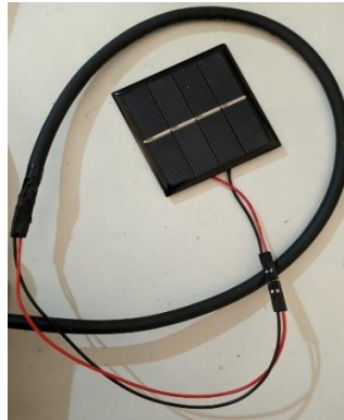
Figura 1.8. Sensor de luz tipo celda/panel RY6-427 [Autor].
