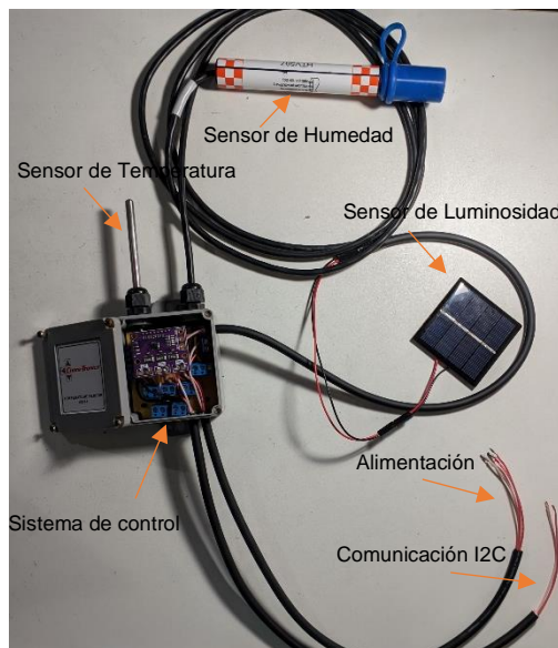
Figura 3.2. Arreglo de sensores completo [Autor].
